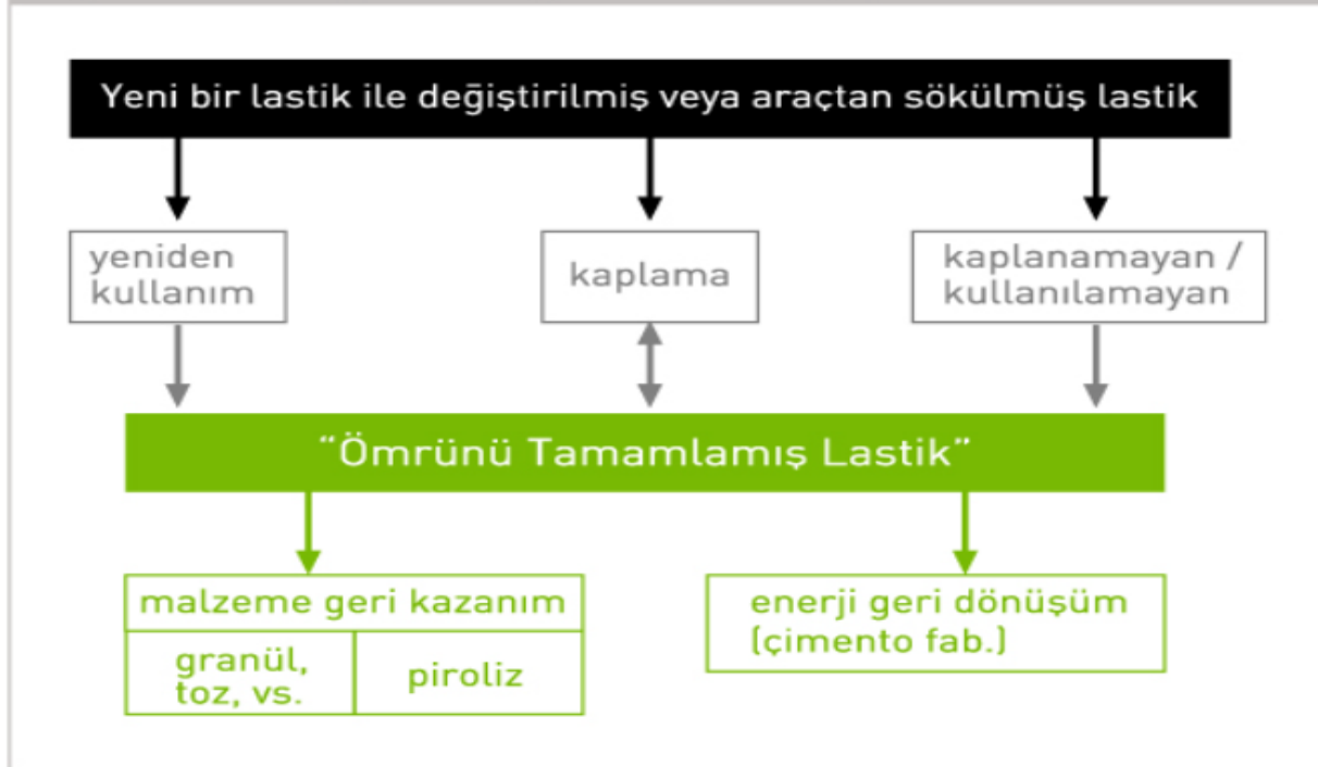
Şekil 3-7 Ömrünü tamamlamış lastiklerin dönüşüm aşamaları
